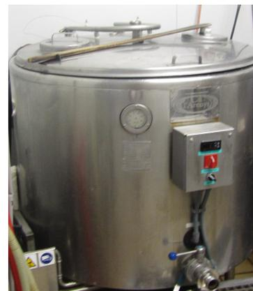
Finalizado este proceso es importante un rápido enfriado del caldo, para eso pasa por unos tubos dobles, por los que en una dirección irá el mosto caliente y por el otro el agua fría del Baias, a medida que se transfieren la temperatura unos a otros el mosto se vierte en el tanque de fermentación desde una altura que permita la oxigenación de este y es en este momento donde se añade las levaduras.
